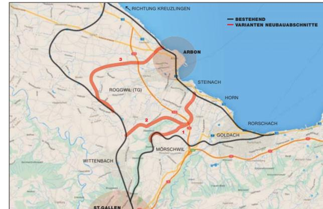
Drei mögliche Linienführungen: Eine Variante zweigt in Mörschwil von der bestehenden Bahnstrecke St. Gallen-Rorschach Richtung Steinach/Arbon ab. Von der bestehenden Bahnstrecke St. Gallen-Romanshorn zweigt eine zweite Variante nach Wittenbach Richtung Steinach/Arbon und eine dritte Variante nach Roggwil-Berg Richtung Arbon ab.
