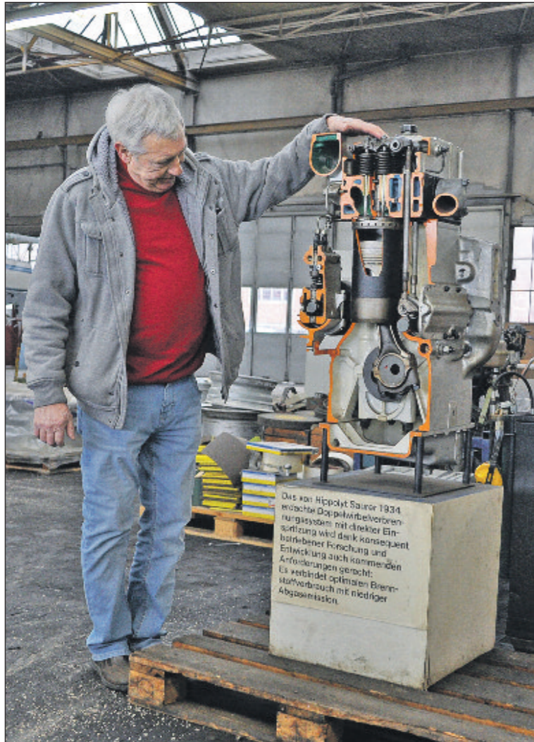
Für Gantruffer Rolf E. Baldinger ein Highlight an der Auktion – ein von Lehrlingen hergestelltes Schnittmodell eines 1934 von Hippolyt Saurer erdachten Doppelwirlverbrennungssystems mit direkter Einspritzung.
