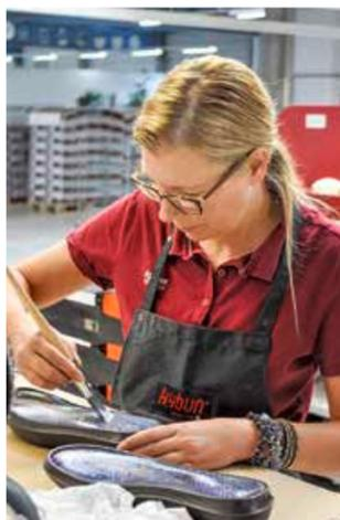
Schlaufenbänder des kyBoot werden angenäht, die Sohle an den Schuh geklebt.
