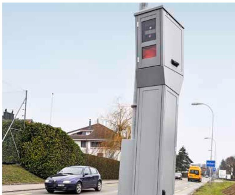
Der graue Kasten an der St. Gallerstrasse in Stachen ist kein «Blitzer», sondern ein Gerät zum Scannen von Kontrollschildern.
