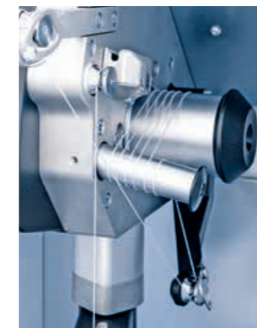
Weltneuheit: Der Sensor «Qualityguard» überwacht laufen den Zwirnprozess.
