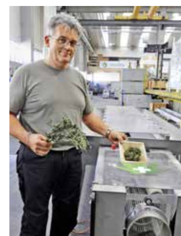
Die Cannabis-Pflanze wird im «Trimmer» (vorne) vom Stiel getrennt. Zuvor wird sie im Fördertisch «Feeder» (Maschine im Hintergrund) auf diesen Prozess vorbereitet.
