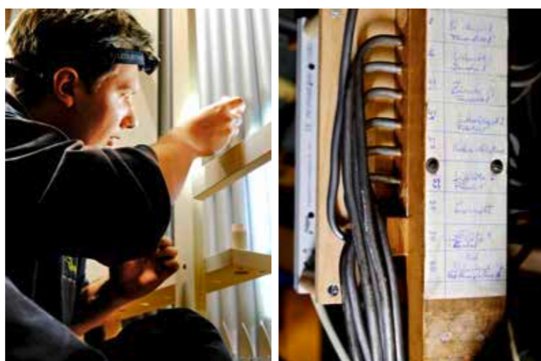
Orgelbauer am Werk (links). In der Orgel finden sich alte handschriftliche Pläne neben den Luftröhren aus einer Zink-Blei-Legierung (rechts).
