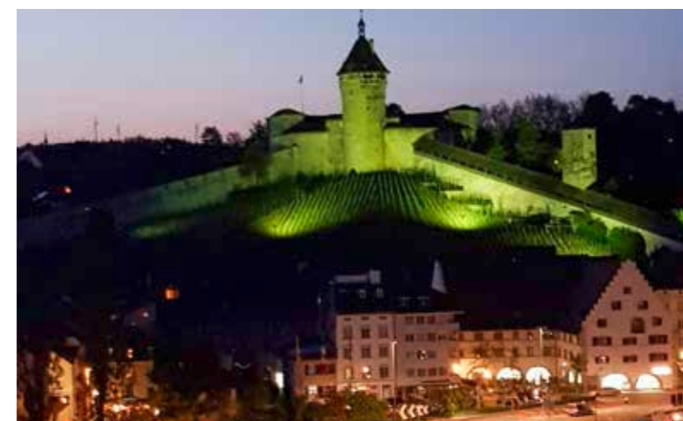
Der Munot, das Wahrzeichen von Schaffhausen, wurde bis 2019 mit Quecksilberdampflampen beleuchtet (Bild). Aufgrund des Verbots dieser Beleuchtungsart erstellte ein Lichtplanungsbüro ein neues Beleuchtungskonzept. Bei der Erstellung des Konzepts wurde mit einberechnet, dass der Munot auch Lebensraum unterschiedlicher Tierarten ist, was ausschlaggebend für das heute warme, goldweisse Licht der Beleuchtung ist. z.V.g.
