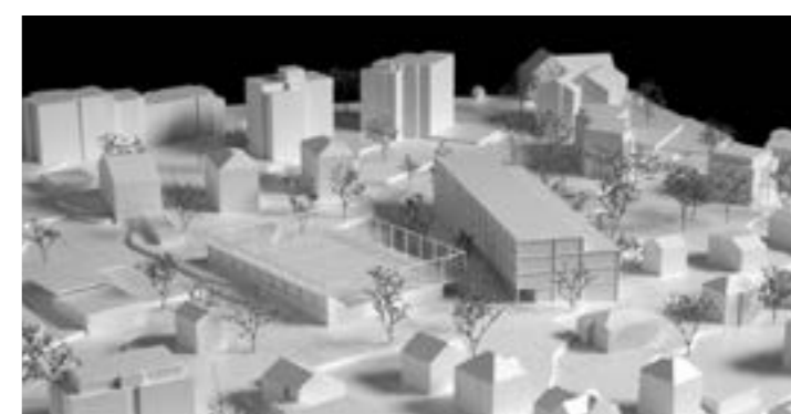
Das Modell vermittelt einen Überblick, wie die teils in das Terrain abgesenkte Dreifach-Sporthalle mit darüberliegendem Allwettersportplatz (links, zur St. Gallerstrasse hin) und der abgespreizte Schulhausneubau (rechts) in das Baugrundstück «Lärche» und das Quartier eingefügt werden.
