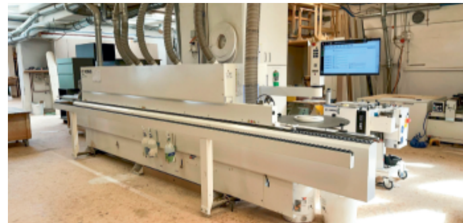
Die neue Kantenleimmaschine sorgt für präzisere Ergebnisse und effizientere Abläufe. z.V.g.
